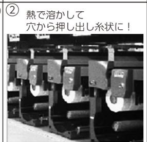
熱で溶かして穴から押し出し糸状に！
