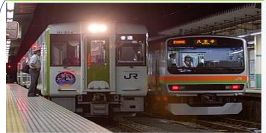
非電化区間の主力車両キハ110系（左）と電化区間の主力車両E231系3000番台（右）
