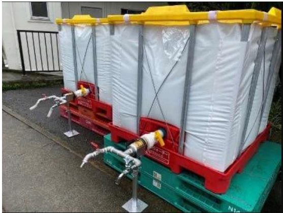
▲災害貯水タンク
